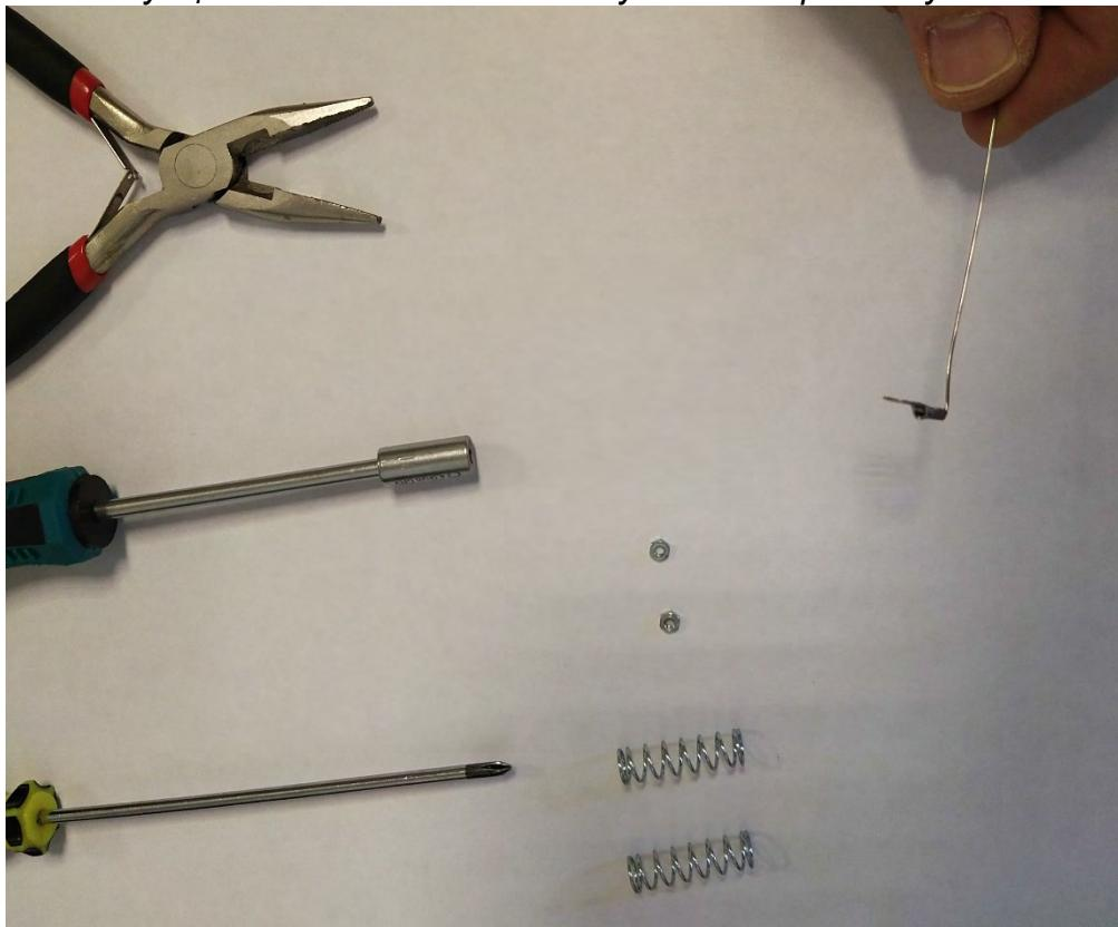
*Выдвигаем основу устройства и фиксируем в этом положении с помощью двух стержней. Откручиваем старое лезвие. Если пружины не потерялись, их можно использовать в дальнейшем.*
