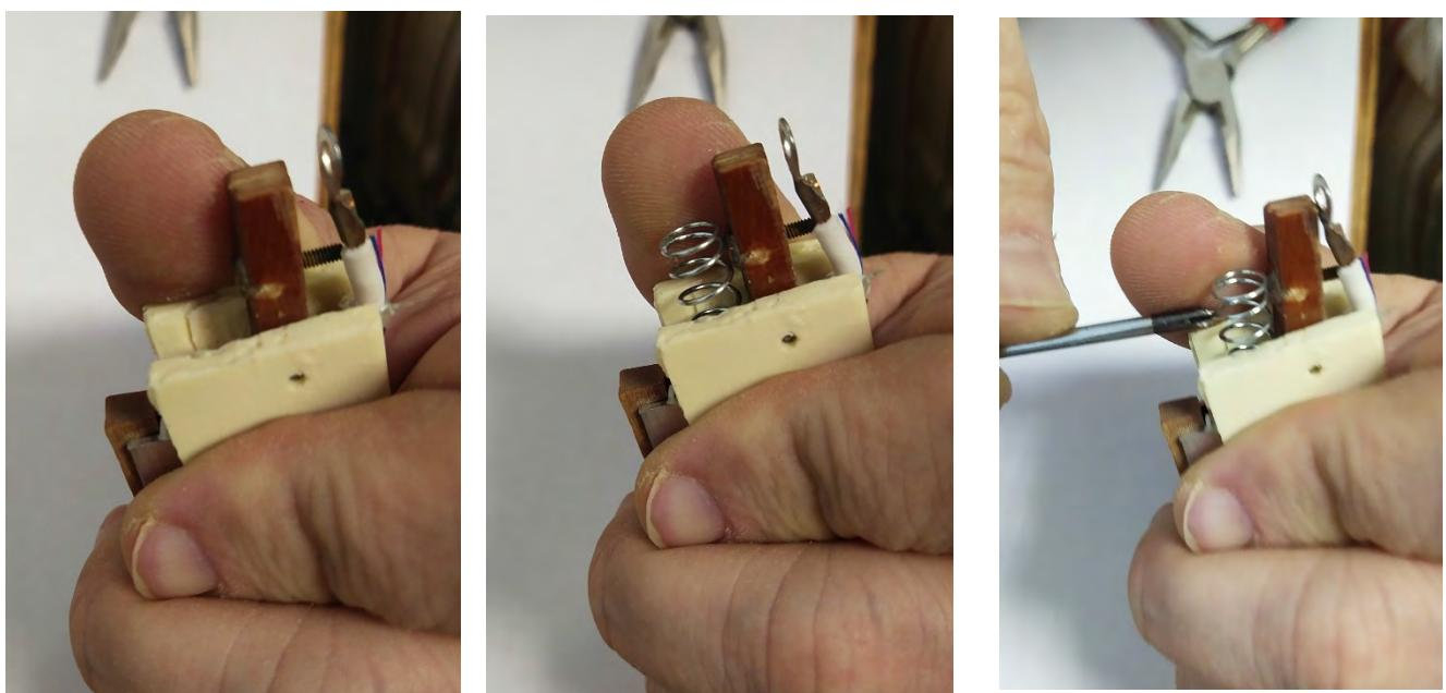
*Фиксируем в сжатом положении пружину «качелькой» и контактами.*
